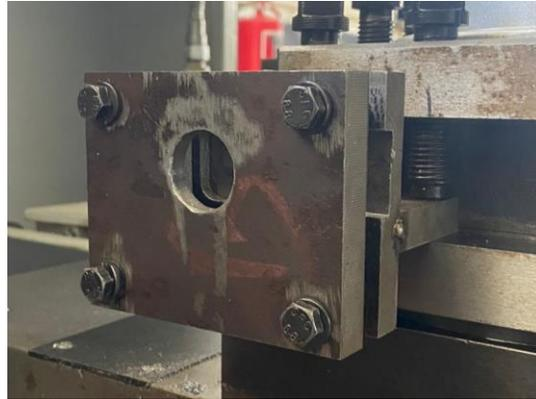
**Figura 2.** Sistema de sujeción de placas para torno CNC.
